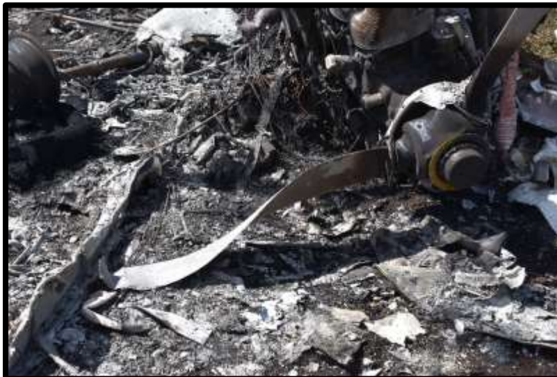
Fotografía No. 08 Vista de la hélice doblada por acción de la temperatura.
