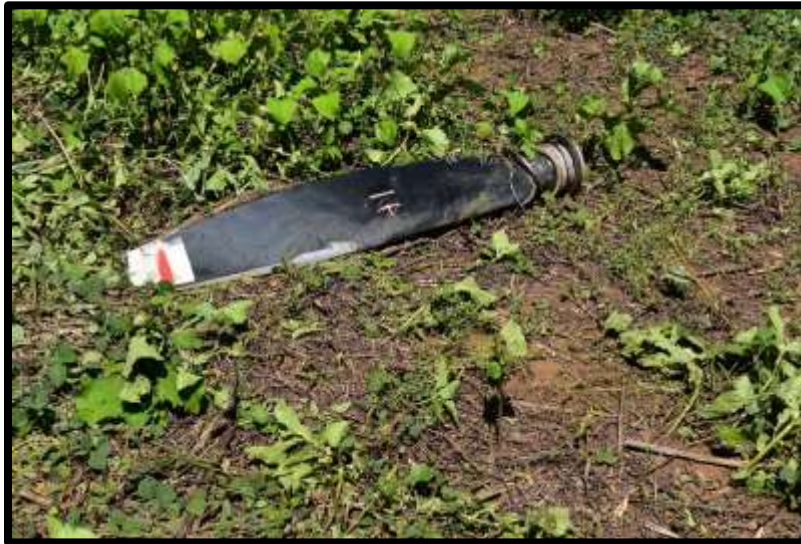
Fotografía No. 11 Pala fracturada de la hélice en el primer contacto a tierra.
